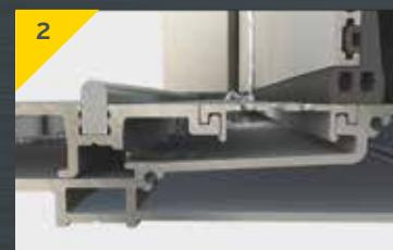
**3** Низкий порог состоит из 3 различных профилей, имеющих необходимые наклоны и отверстия, облегчающие скрытый отток воды к наружной части конструкции.
